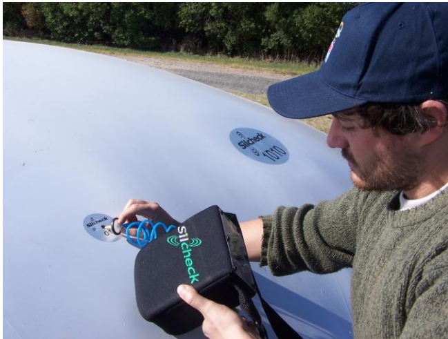
Figura 11. Medición de CO 2 con el sistema Silcheck, donde se observa la identificación de la bolsa (1010) y del sitio de muestreo (01).
