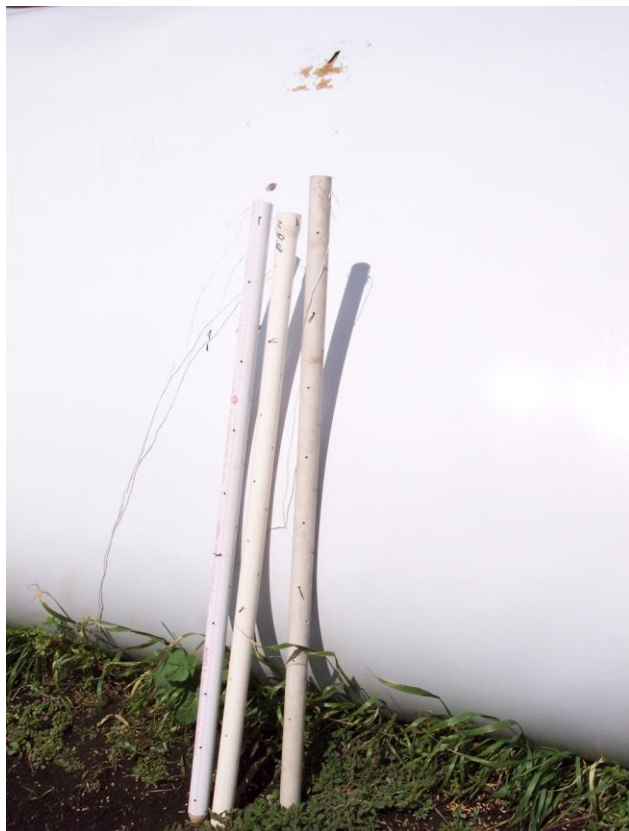
Figura 5. Detalle de los caños que contenían los tubos con insectos en su interior. Se puede observar la perforación de los caños y el corte en el silo bolsa por donde se introdujeron los caños.
